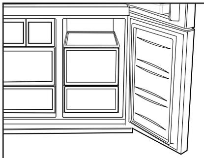
**i** Переключение между режимами холодильного и морозильного отделений позволяет охлаждающий элемент, находящийся в закрытом отделении (отделение компрессора) за холодильником. Когда этот элемент работает, из холодильника доносится шум, похожий на тиканье механических часов. Это вполне нормально и не является причиной неисправности.
