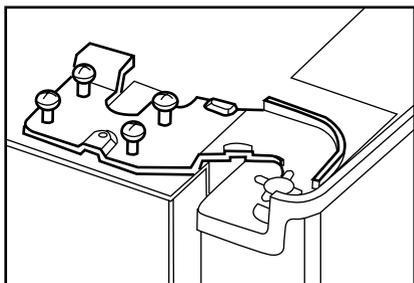
**i** Зафиксируйте отрегулированную дверь, затянув винты, не изменяя положения двери.
