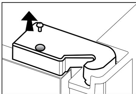
❗ Используя отвертку, выньте винт из крышки верхней петли той двери, которую нужно отрегулировать.
