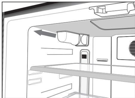
3. Снимите крышку обводной линии водяного фильтра, вращая ее вниз.
