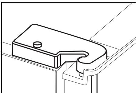
**i** Установите на место крышку петли и зафиксируйте винтом.
