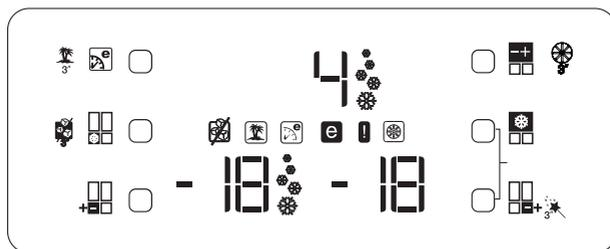
Если нажать кнопки в правильной последовательности, символ блокировки кнопок погаснет, индикатор предупреждения о замене фильтра включится и вскоре будет активирован зуммер. После замены фильтра нажмите кнопку отключения предупреждения о замене фильтра (номер 19 в описании дисплея) для автоматического определения времени использования фильтра.
